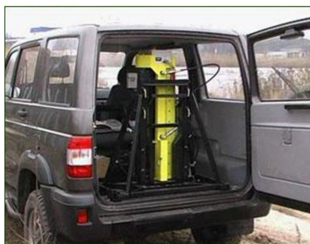
Рисунок 44. Автоматические пробоотборники почвы устанавливаются на различных транспортных средствах: от квадроцикла до полноприводного грузовика или трактора. Автоматический почвенный пробоотборник представляет собой агрегат, смонтированный как навесное оборудование на задней части рамы движителя, и работает от электрического двигателя, питающегося от аккумуляторной батареи автомобиля, который приводит в действие гидравлическую систему, непосредственно производящую отбор проб посредством буров. Пробоотборник оснащается блоком управления, управляющей электроникой, датчиком и регулятором рабочего давления.
