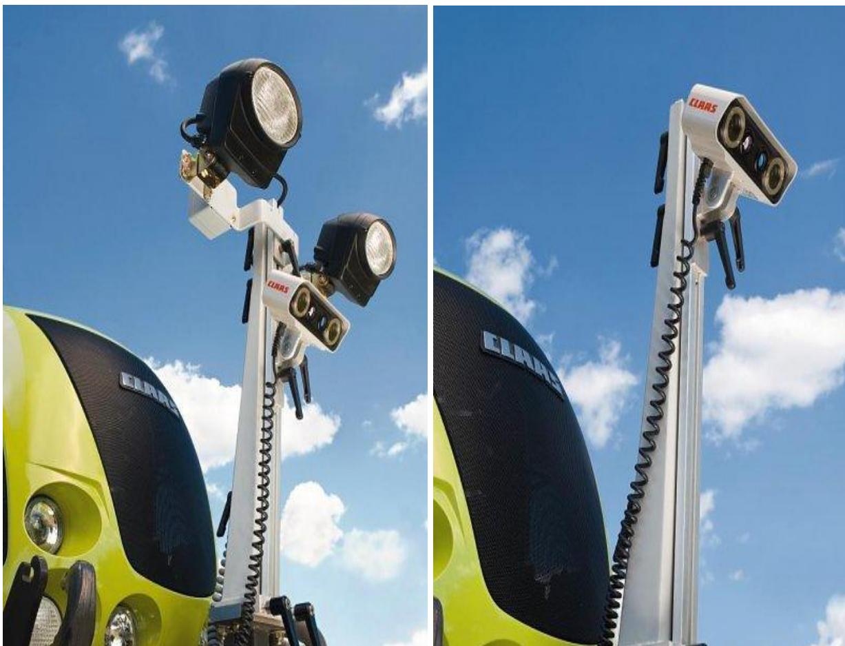
Рисунок 62. Электрооптический датчик системы Claas CAM PILOT установленный на грузах, предназначенных для увеличения сцепного веса, в передней части трактора.
