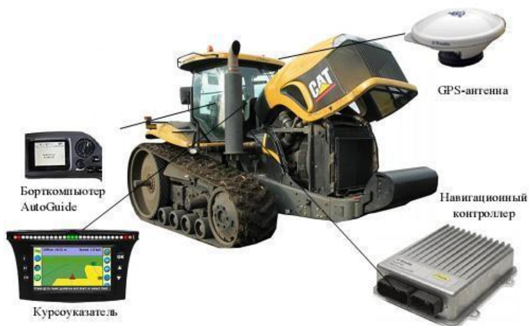
Рисунок 55. Основные элементы системы автоматического вождения сельскохозяйственной техники Trimble AgGPS Autopilot.
