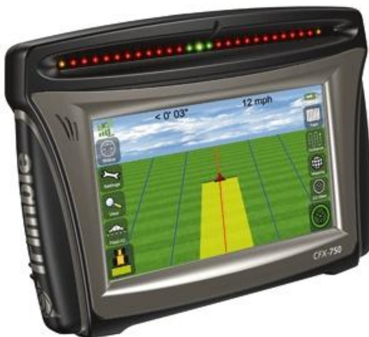
Рисунок 73. Базовый блок системы параллельного вождения Trimble CFX-750.
