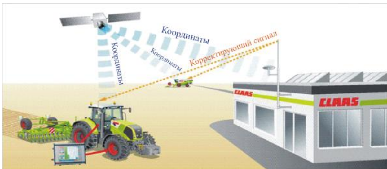
Рисунок 42. Технология RTK (Real Time Kinematic).
