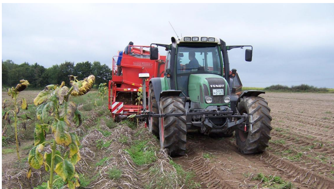
Рисунок 63. Автопилот с оптическим датчиком EYE-DRIVE (CAM PILOT) в работе.
