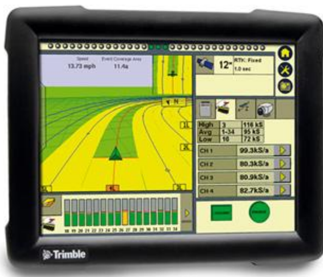
Рисунок 72. Базовый блок системы параллельного вождения Trimble AgGPS FmX.
