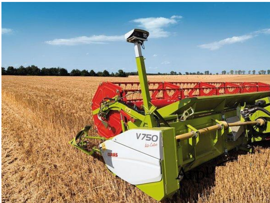
Рисунок 54. Оптический датчик системы автоматического вождения сельскохозяйственной техники Claas Laser PILOT установленной на жатке комбайна.
