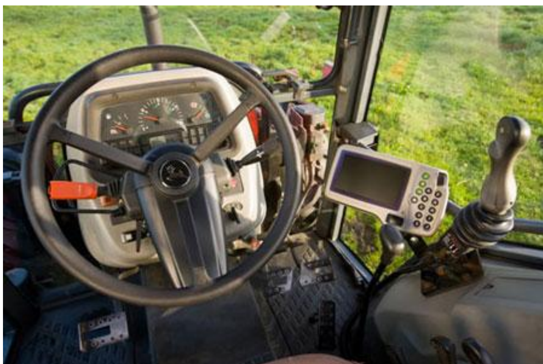
Рисунок 57. Элементы управления системы автоматического вождения сельскохозяйственной техники John Deere - Greenstar Autotrac.
