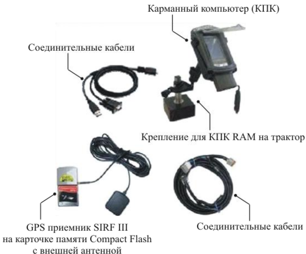
Рисунок 43. Состав типовой системы дифференцированного внесения удобрений и средств защиты растений.
