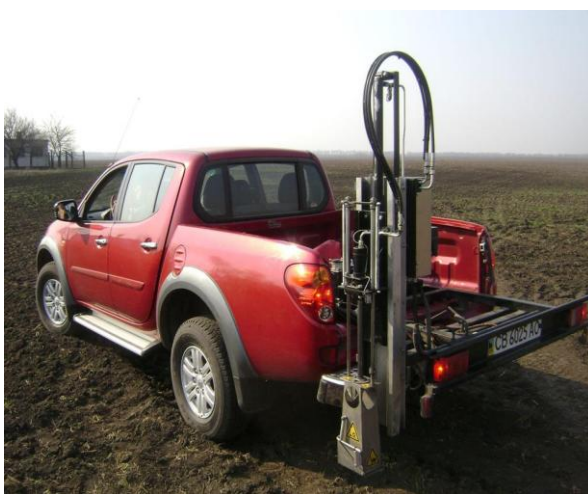
Рисунок 44. Автоматические пробоотборники почвы устанавливаются на различных транспортных средствах: от квадроцикла до полноприводного грузовика или трактора. Автоматический почвенный пробоотборник представляет собой агрегат, смонтированный как навесное оборудование на задней части рамы движителя, и работает от электрического двигателя, питающегося от аккумуляторной батареи автомобиля, который приводит в действие гидравлическую систему, непосредственно производящую отбор проб посредством буров. Пробоотборник оснащается блоком управления, управляющей электроникой, датчиком и регулятором рабочего давления.
