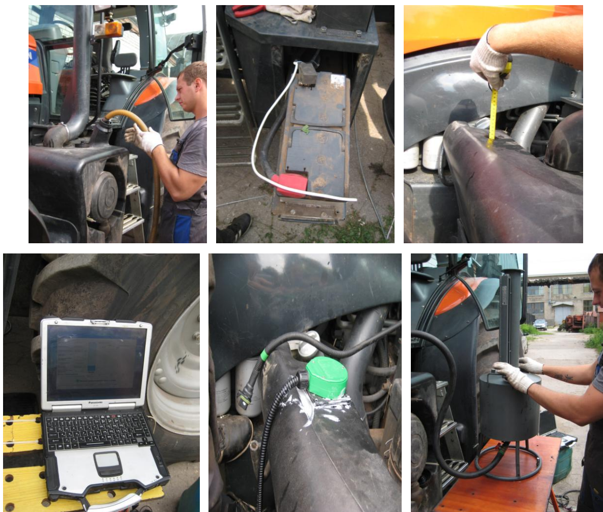
Рисунок 76. Установка системы СКАУТ на самоходную машину ФГБОУ ВПО РГАТУ.
